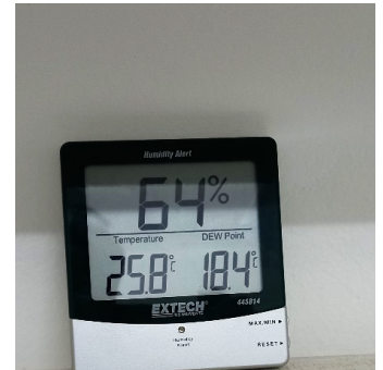
Figure 6 : Hygrothermomètre pour la mesure de la température et de l'humidité
