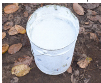
Figure 2 : seau métallique pour la préparation du lait de chaux
