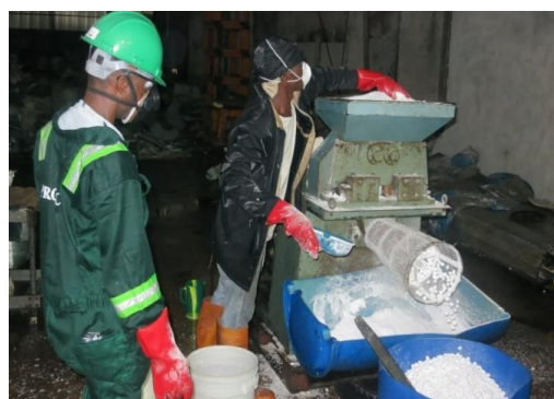
Figure 2: granulation de l'urée perlée pour obtenir les super granules d'urée (SGU)
